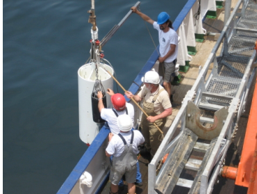
Decksmannschaft und Techniker der MS METEOR beim Ausbringen des drei Tonnen schweren Kolbenlots für eine Kernbohrung. Foto: Ralph Schneider, Copyright: CAU
